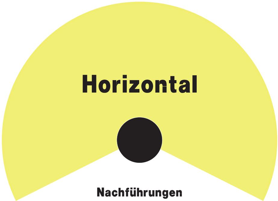
Um eine Photovoltaik genau der Sonne nachzuführen, ist eine zweiachsige Nachführung erforderlich. Eine horizontale Nachführung, die nach links und rechts schwenkt. Eine vertikale Nachführung nach oben und bis zum Horizont nach unten. Der Sinn der Nachführung ist dafür zu sorgen, daß das Sonnenlicht immer senkrecht auf die Photovoltaik strahlt. Fällt das Sonnenlicht nicht genau senkrecht auf die Photovoltaik, dann bekommt diese weniger Licht und liefert weniger Strom.
